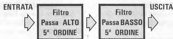
Fig.29 Per realizzare dei filtri PASSA-BANDA molto stretti, cioè con un elevato Q , si potrà utilizzare un primo filtro Passa-Alto con in serie un secondo filtro Passa-Basso. Usando dei filtri di 3° ordine sui due fronti si otterrà un'attenuazione di 18 dB x ottava, utilizzando invece dei filtri di 5° ordine, un'attenuazione di 30 dB x ottava.
