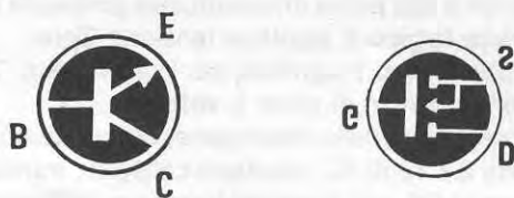
Fig.2 Per i Primi Passi vi proponiamo questo semplice tester in grado di provare, oltre a tutti i tipi di Transistor, anche i Mospower. Utilizzando un Mospower, il Gate lo inserirete nella boccia B, il Drain nella boccia C ed il Source nella boccia E.
