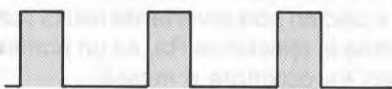
Fig.5 Se il tempo in cui il transistor rimane chiuso risulta minore del tempo in cui rimane aperto (duty cycle 40%), sull'uscita vi ritroverete una tensione minore del 50%.
