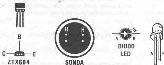
Fig.6 Connessioni del transistor ZTX.604 e della sonda visti da sotto e dei due terminali A-K del diodo led.
